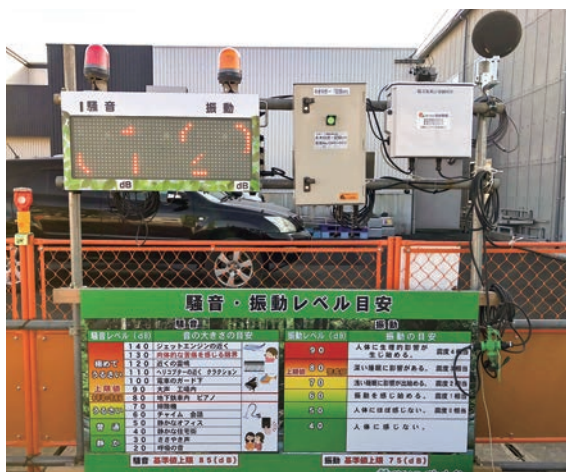
記録ch 騒音振動計 騒音振動表示機
