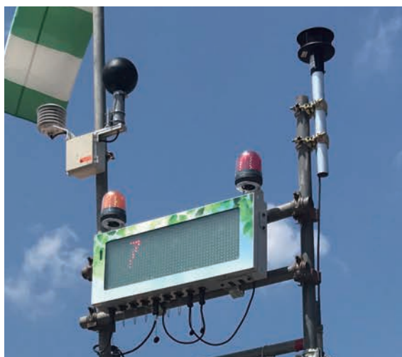
WBGT 風向風速計 表示ch
