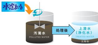
無機系の凝集剤(粉体)で、本製品【1剤】を汚濁水に直接投入・攪拌するだけで、【中和しながら、水をきれいにする】という「水環境保全製品」です
