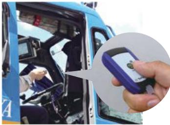
従来品と比較して吊荷移動中の注意喚起が容易に実現可能です。また、移動中のみブザー音を響かせることで、作業員の意識を吊荷へ促します。
