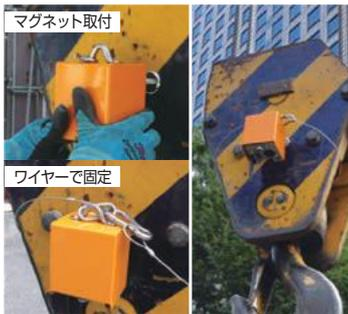
フックブロックに装置を取り付けることで、吊荷警報器本体の接触故障を大幅に軽減できます。
