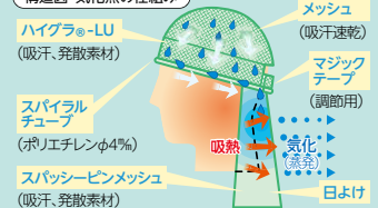
構造図・気化熱の仕組み
